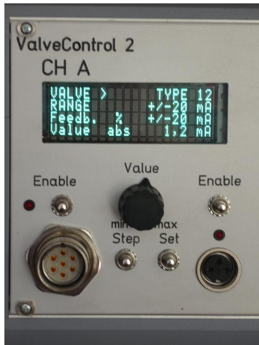
Oberhalb der Ausgangsbuchsen befinden sich die Taster „**Enable**“ zum Aktivieren der Ausgänge. Die Ausgänge werden 1 s nach Drücken der Taste „Enable“ freigeschaltet. Links, bzw. unter der jeweiligen Taste zeigt eine rote LED an, ob der Ausgang aktiv ist. Mit dem Potentiometer „**Value**“ wird der Sollwert für den analogen Ausgang eingestellt.
